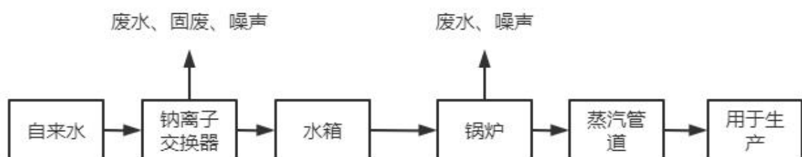
图 2-3: 软水制备工艺流程及产污节点图
