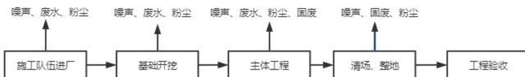
图 2-1 本项目工艺流程及产污节点图
