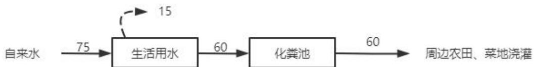
图 2-1 水平衡图 (t/a)
